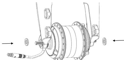
4. Ziehen Sie die BC3/8 Hutmuttern an beiden Seiten des Motors mit einem Maulschlüssel im Uhrzeigersinn fest. Erforderliches Drehmoment: 30-36N.m.
